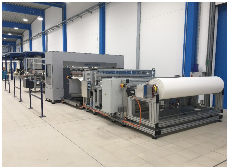
Die neue Plissiermaschine am Einsatzort nach Aufbau und Inbetriebnahme, Quelle: Junker-Filter GmbH
